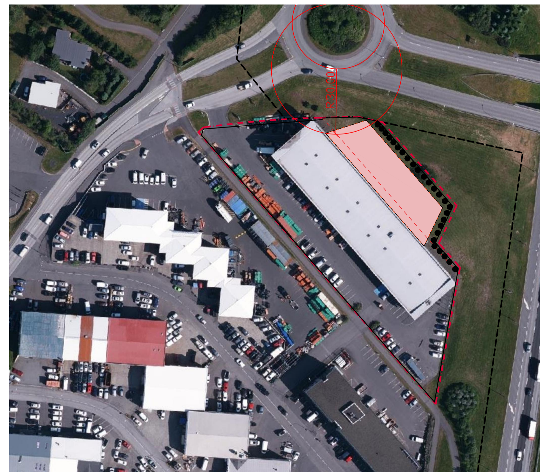
Skýringarmynd: Loftmynd sem sýnir tillögu að breytingu með fjarlægð frá miðu akbrautar hringtorgs
