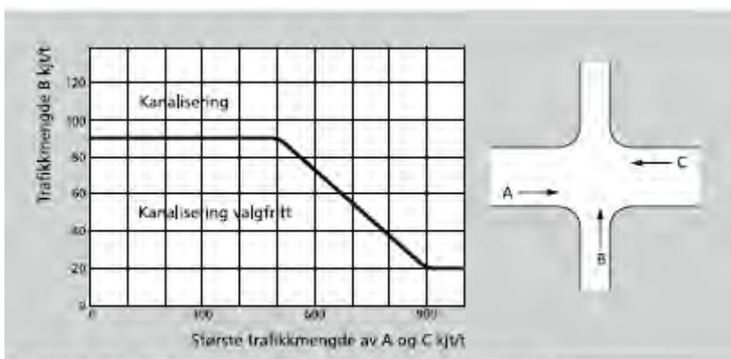
Figur 4.6: Trafikkay i sekundærveg basert på trafikken i dimensjonerende time
