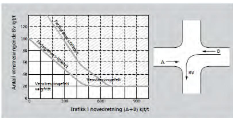
Figur 4.8: Kriterier for vurdering av eget venstresvingefelt basert på trafikken i dimensionerende time
